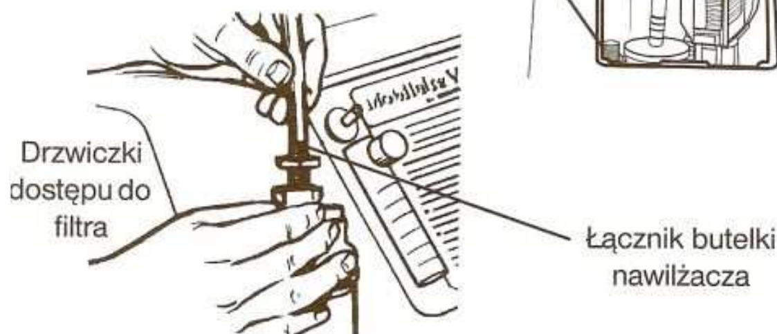
RYSUNEK 5.3 Podłączanie łącznika butelki nawilżacza
