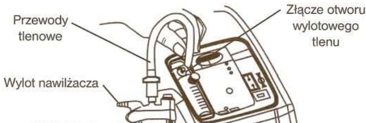
RYSUNEK 5.4 Podłączanie przewodów tlenowych
